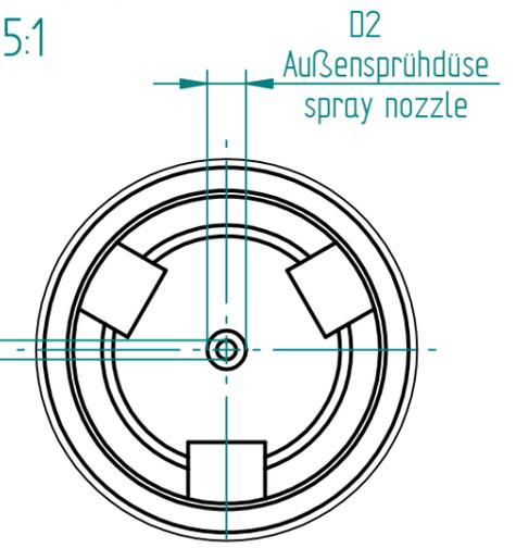
Sprühkopf HTRR mit Rückschlagventil RV5513F
